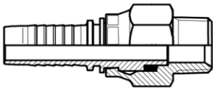
NPT & DREHGELENK Auch mit BSP-zyl-Außengewinde 60°IK lieferbar
