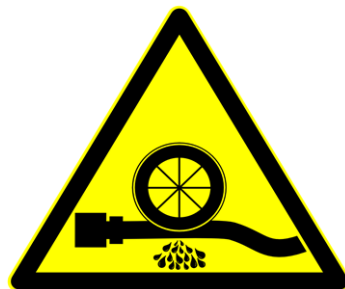
Gefahr durch Quetschen der Schlauchleitung
