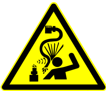
Gefahr durch peitschende Schlauchleitung
