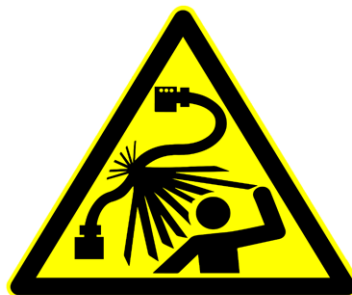
Gefahr durch berstende Schlauchleitung
