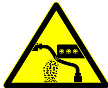
Gefahr durch Abrasion an der Schlauchleitung
